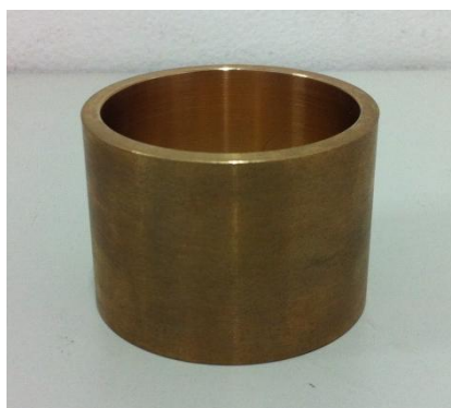
衬套试样实物照片
