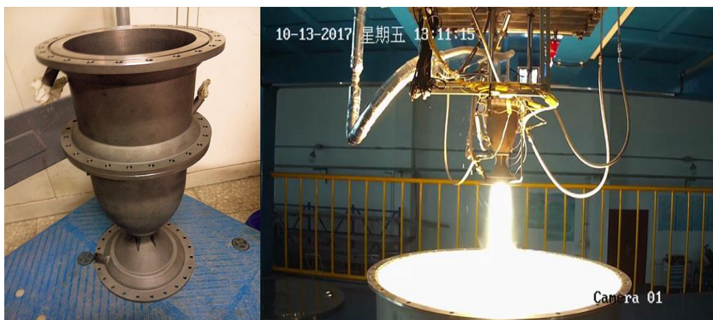
图 1 （a）3D 打印火箭发动机 （b）地面点火及燃烧试验
